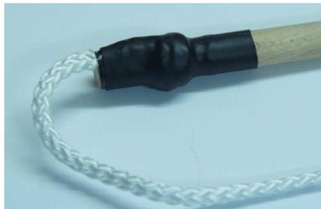
Als Schnur eignet sich eine 3mm Nylonschnur in der Länge von ca. 80cm. Nach dem die Schnur mit unserem Stab fest verbunden ist, umwickeln wir das ganze mit etwas Isolierband.
